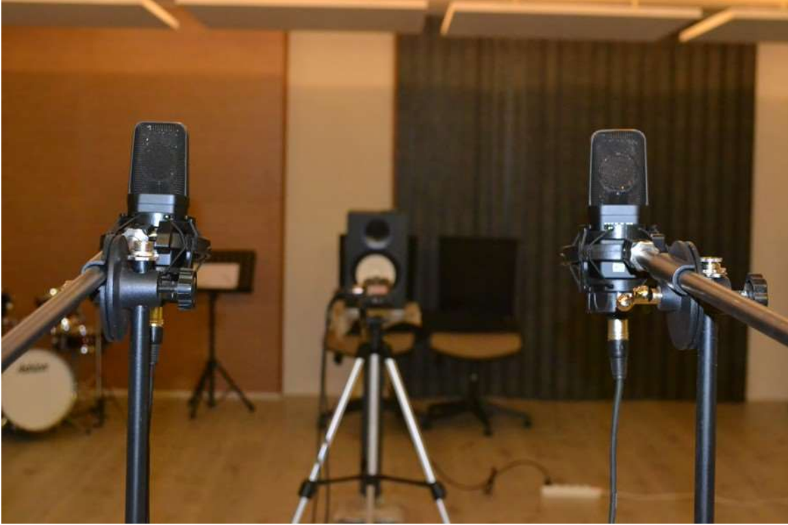
Resim 1. Stüdyo içi örnek ses kaynağı ve mikrofon pozisyonları
