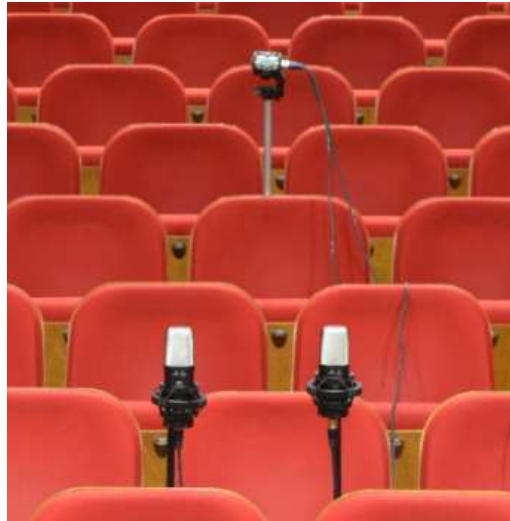
Resim 5. Sweep İşlemi Mikrofon Mozisyonları
